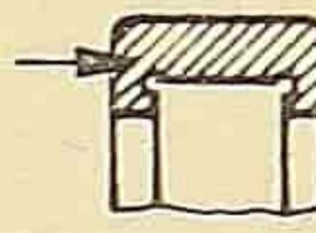
RUB - Uzdignuti deo pored putanje kotrljanja ležaja sa oblicama.
