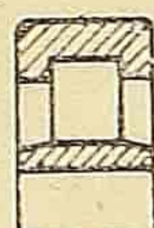
RADIJALNI LEŽAJ – Kotrljajni ležaj koji može da primi opterećenje samo u radijalnom pravcu. Primer: prstenasti ležaj sa kratkim valjcima i prstenom bez vodjice.
