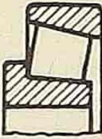
**PODESIVI LEŽAJ** – Kotrljajni ležaj čiji se radijalni zazor određuje pri ugradjivanju.
