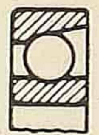
**RAZDVOJIVI LEŽAJ** – Kotrljajni ležaj kod koga međusobno pomeranje tela sa putanjom kotrljanja nije ograničeno na jednu ili obe strane pre ugradjivanja. Primer: prstenasti ležaj sa ramenom.
