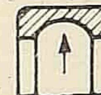
OLUK - Putanja kotrljanja kuglica sa izvodnicom u obliku kružnog luka.
