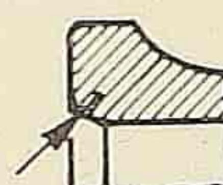
ZAOBLJENJE - Zaobljeni prelaz, na pr. izmedju omotača i čela, ili izmedju provrta i čela.
