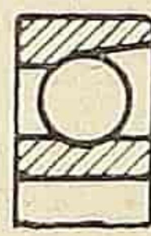
PRSTENASTI LEŽAJ SA RAMENOM - Prstenasti kuglični ležaj sa ramenom i cilindričnom putanjom kotrljanja na spoljnom prstenu, sa olukom na unutrašnjem.
