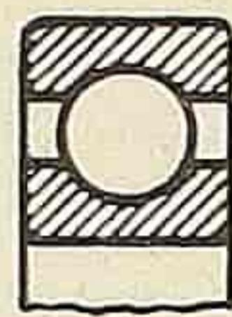
**NEPODESIVI LEŽAJ** – Kotrljajni ležaj čiji je radijalni zazor određen pri izradi.
