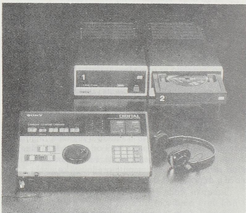
Slika 4. Novi digitalni „gramofon” za emitovanje radio-programa. Sistem se sastoji iz dva reproduktora i upravljačke jedinice
