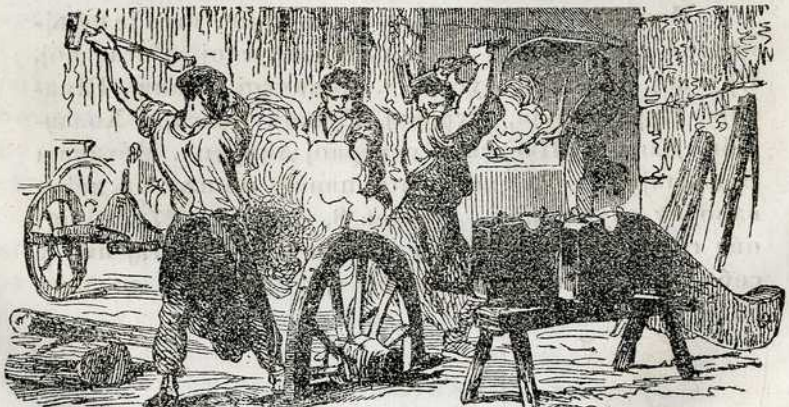
Укввање шине на точку.
